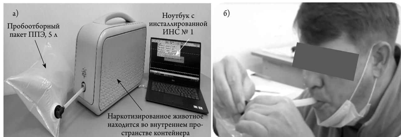
**Рис. 1. а) Внешний вид анализатора газов (биогибридного детектора) модели «БГС-АПК 02С33» и б) порядок отбора проб выдыхаемого воздуха у добровольца**
