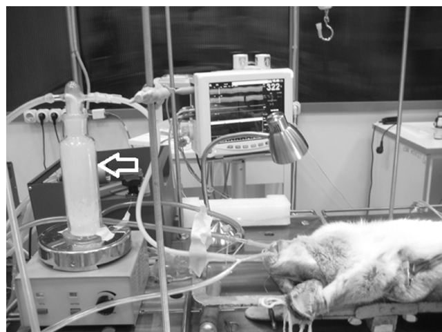
Рис. 1. Фотография генератора аэрозоля (отмечено белой стрелкой) в составе лабораторной установки Fig. 1. Photo of aerosol generator (marked by white arrow) in setup
